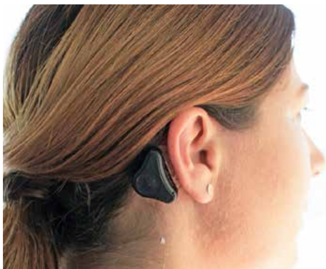
Abbildung 2: ADHEAR®-System, welches mittels Haftpfaster hinter dem Ohr befestigt wird. Foto: Med-el
